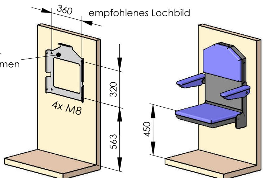
Sitzfläche klappt mittels Federkraft automatisch hoch.
